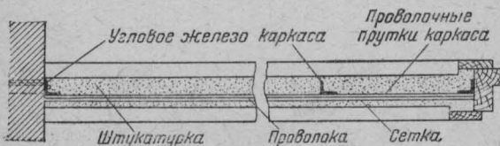
Рис. 35. Перегородка по сетке Рабица.
