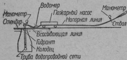
Рис. 340. Установка для испытания водопровода низкого давления.
