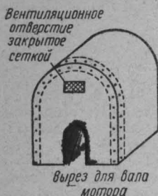
Рис. 125. Кожух для электродвигателя.
