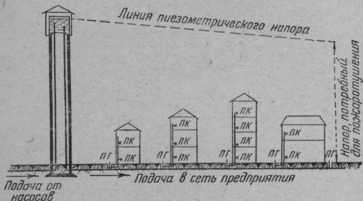
Рис. 295. Схема устройства водопровода высокого давления.
