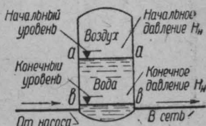
Рис. 325. Схема работы пневматической установки.
