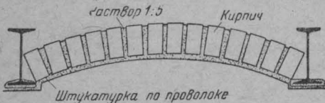
Рис. 16. Перекрытие — кирпичные сводики по металлическим балкам.
