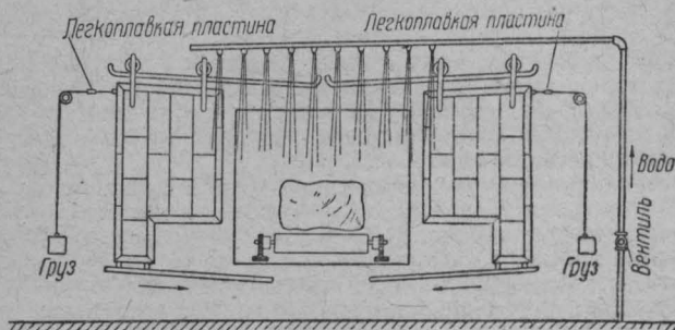
Рис. 53. Дверь автоматическая для проема, через который проходят транспортеры.
